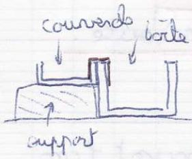
Mettre un support sous le couvercle pour être au même niveau pour la boîte et le couvercle. Coller et laisser sécher.
